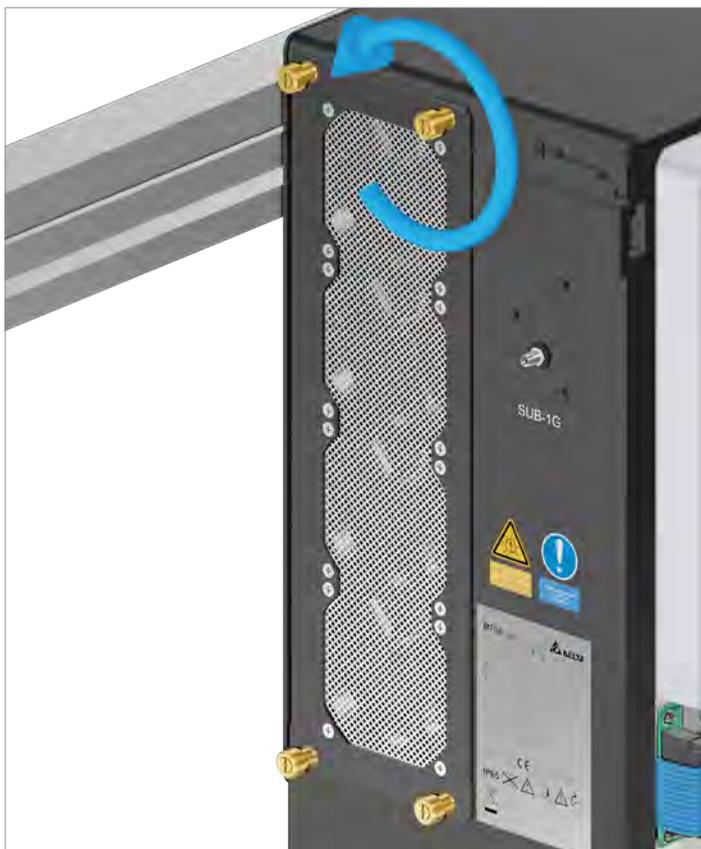
1. Das Lüftermodul abschrauben und entfernen.
