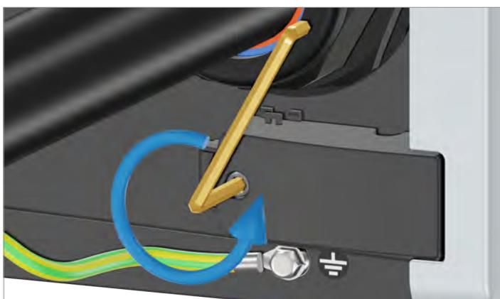
7. Die Abdeckung der unteren Türverriegelung aufschrauben und öffnen.
