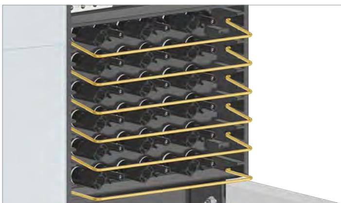
2. Die Metallbügel zur Abstützung der DC-Kabel einsetzen.
