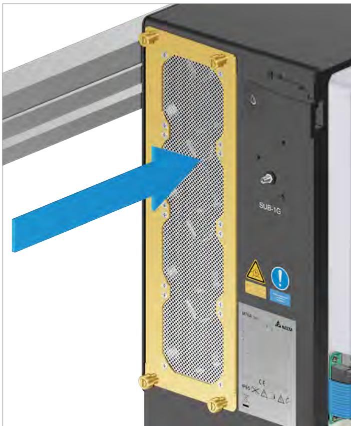
5. Das Lüftermodul so einsetzen, dass sich die Stromversorgungskabel auf der rechten Seite des Lüftermoduls befinden.
