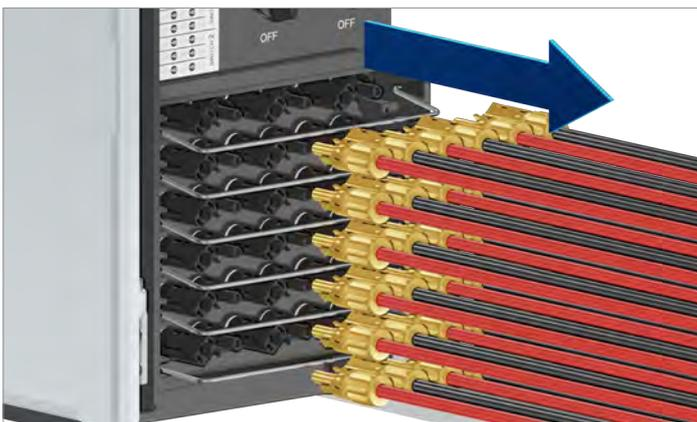
4. Die DC-Kabel mit dem Montageschlüssel lösen und abziehen.
