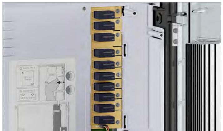
Abb. 4.14: Ansicht der DC-Überspannungsableiter bei entfernter Abdeckung
