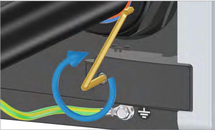
4. Den Sechskantschlüssel in die obere Türverriegelung stecken.
