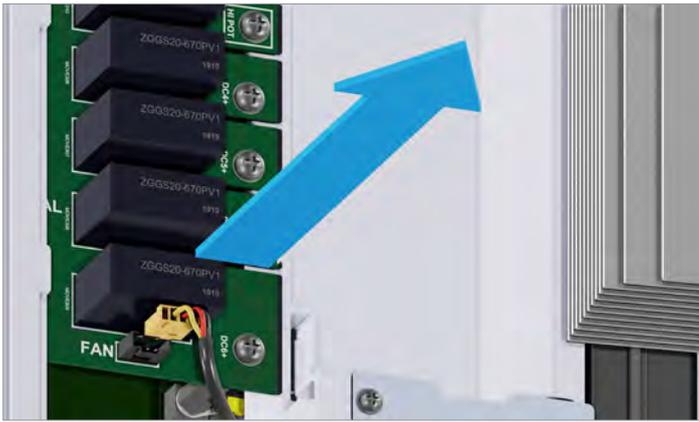
2. Das Stromversorgungskabel des internen Lüfters 2 herausziehen.
