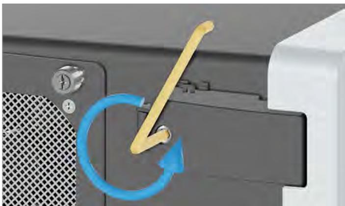
6. Die Abdeckung der oberen Türverriegelung aufschrauben und öffnen.
