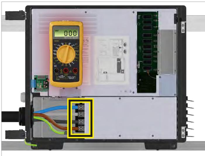
10. Mit einem Spannungsmessgerät prüfen, dass am AC-Klemmenblock keine Spannung mehr anliegt.
