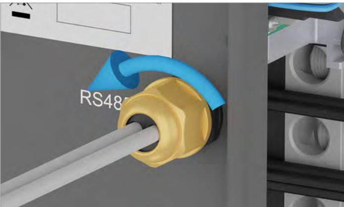
2. Die Kabelverschraubung des Kommunikationsanschlusses abdrehen und Kabel, Kabelverschraubung sowie Dichtung herausziehen.
