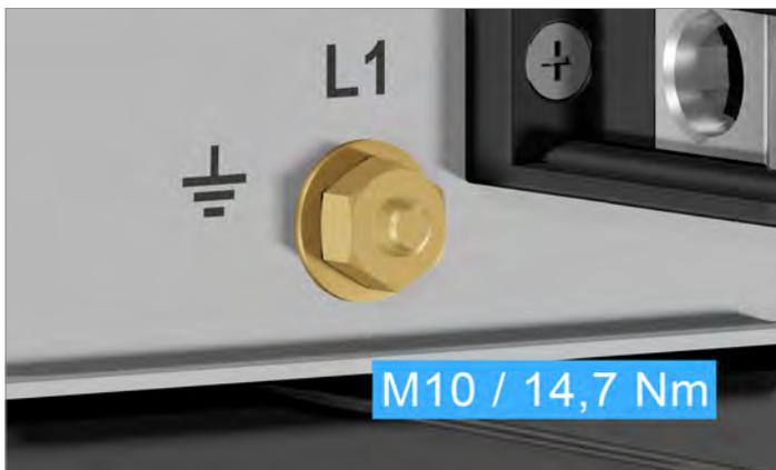
1. Das PE/PEN-Kabel an der PE-Schraube anschrauben (Drehmoment: 14,7 Nm). M8-Mutter, Federring und Unterlegscheibe sind vorhanden.
