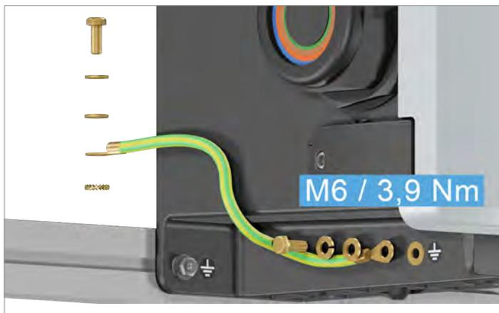
1. Das Erdungskabel an der linken Unterseite des Wechselrichters anschrauben (Drehmoment: 3,9 Nm). Dafür werden M6-Schraube, Federring und Unterlegscheibe benötigt. Eine Zahnscheibe wird **nicht** benötigt.
