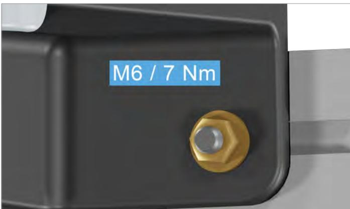
6. Den Wechselrichter unten rechts mit M6-Schraube, Federling und Unterlegscheibe an der Wand oder dem Montagesystem festschrauben.
