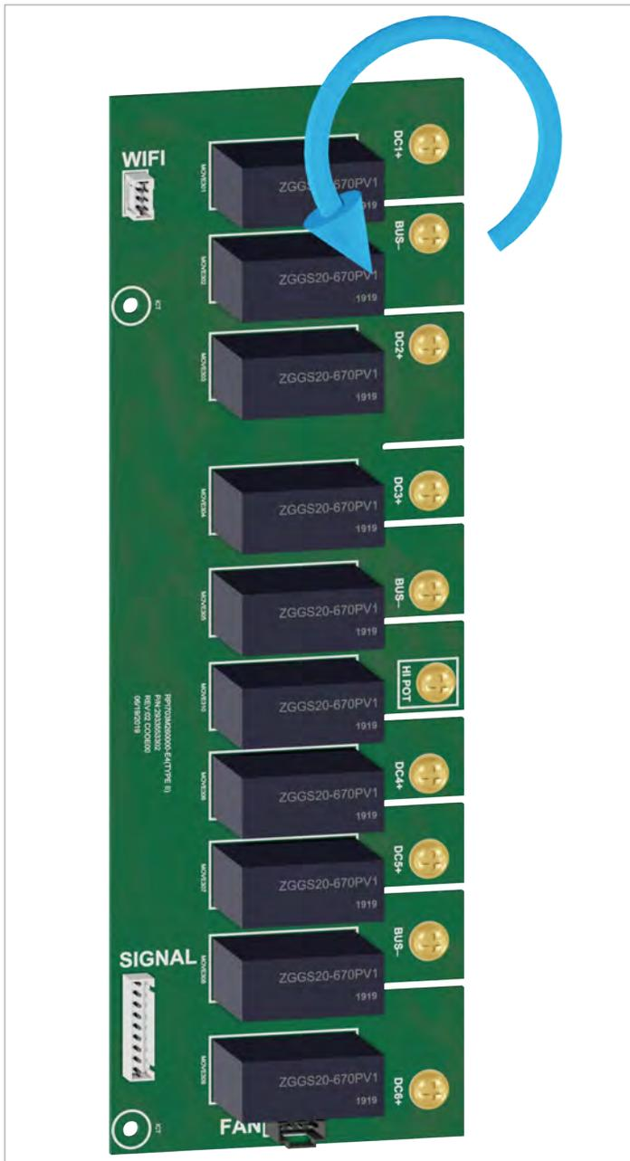
1. Die 10 Schrauben rechts (für den DC-Bus) an den alten DC-Überspannungsableitern herauserschrauben.
