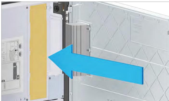
4. Die Abdeckung der DC-Überspannungsableiter einsetzen.
