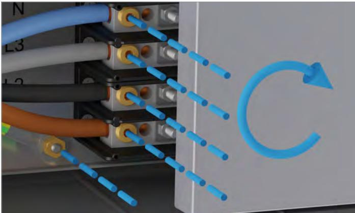
2. Die AC-Kabelverschraubung festschrauben.
