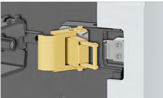
5. Die Abdeckung der unteren Türverriegelung aufschrauben und öffnen.
