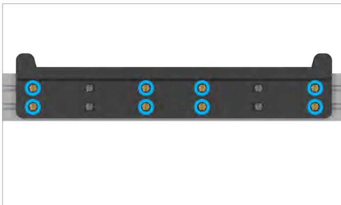
1. Die Montageplatte mit mindestens 8 M6-Schrauben an der Wand bzw. dem Montagesystem befestigen.
